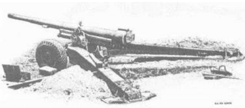
Cañón Puteaux de calibre 155/38 de origen francés. Foto: gentileza Armada de Chile.
